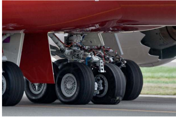
Een Boeing 747-8 (startgewicht 442.000 kg) krijgt een onverwachte klapband tijdens de landing na een testvlucht. Banden ondergaan regelmatig tests om zeker te stellen dat ze 30-40% uitzetting kunnen weerstaan.
